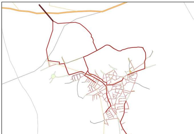
Cuenta con cuatro colectores principales a los que vierten los ramales secundarios. La red está realizada con tuberías de hormigón con unos diámetros entre 30 y 70 centímetros, y está situada a una profundidad entre 1,00 y 1,20 metros.
